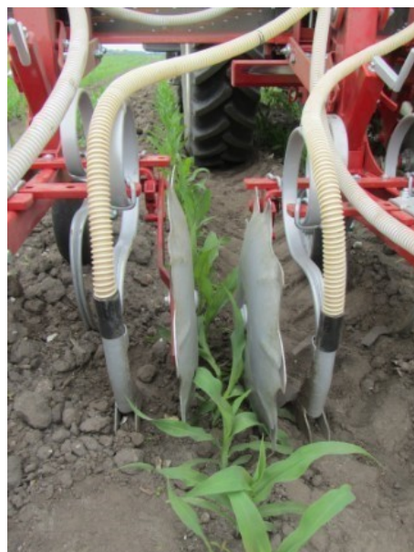
Billede 1. Billedet viser gødningsudstyr, monteret på en radrenser. Gødningen lægges i jorden 10 til 15 cm fra rækken bag den yderste tand på radrenseren. Gødningen kan enten placeres på den ene side af rækken eller på begge sider af rækken som vist på billedet. Foto: Henning Sjørsløv Lyngvig, SEGES.
